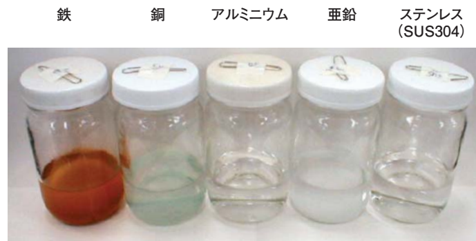
図3 各種テストピースを浸漬(37℃ 7日間)した「サニクイック」溶液の外観変化
