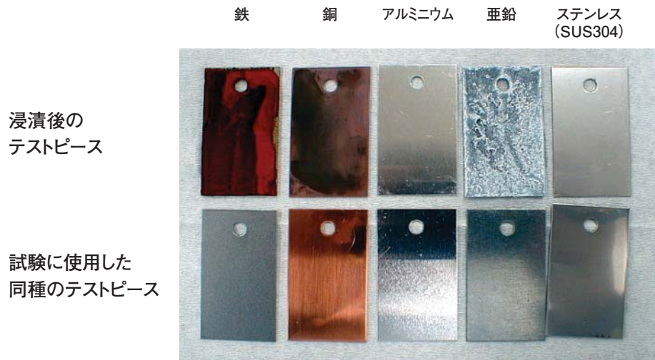
図2 「サニクイック」に浸漬(37℃ 7日間)した各種テストピースの外観変化
