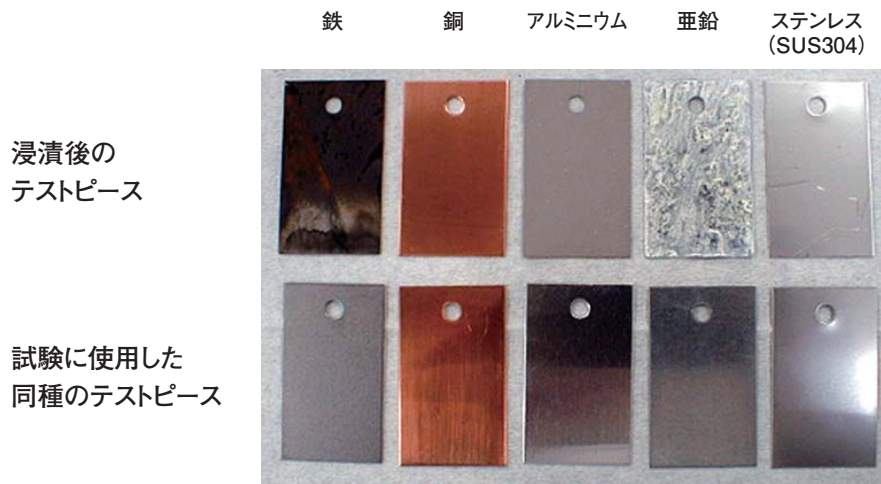
図4 「プロベスト」に浸漬(37°C 8日間)した各種テストピースの外観変化
