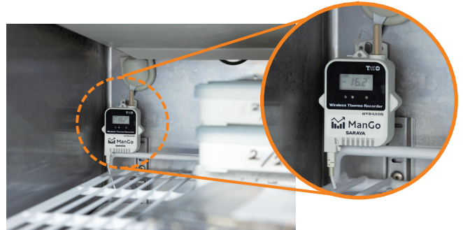
ワイヤレス温度計による冷機器自動温度測定
