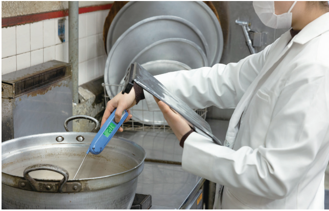
iPadと連動させて中心温度を測定
