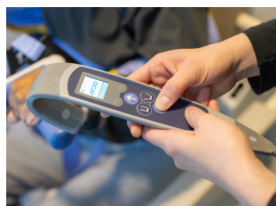
Sara ® Flexの操作リモコンボタンは4つ (リフトの昇降と、キャスター部分の開閉)
