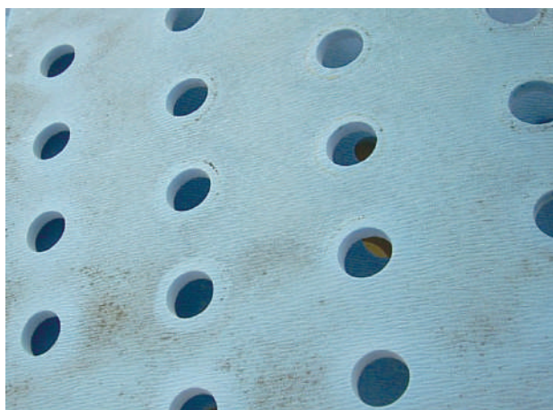
図6 スポンジ様構造のマット汚染の例 表面はきれいに見えても、取り外して確認すると 汚れが確認できる
