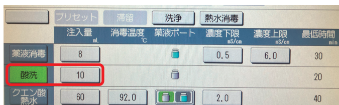
図4 多人数用透析装置の 希釈濃度変更 (100倍→200倍)
