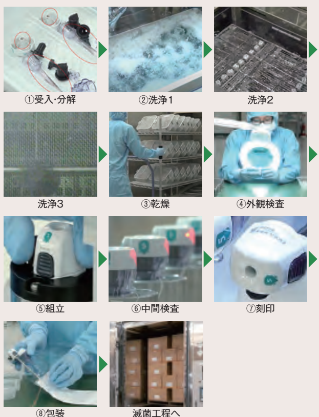
写真2 再製造トロカター製造工程の一部
