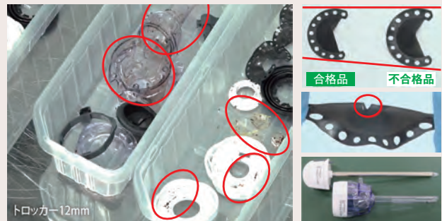
写真1 部品レベルまで分解したSUD 内部に隠れた破損や亀裂、膨潤や汚れを発見除去する
