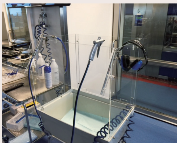
写真4 エアーガンシステムとも呼ぶのでしょうか。アアーをかけるときはボックス内に洗浄物をセットし、ヘッドホンを装着します。
