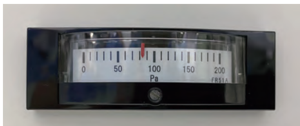
図8 組立てエリアの気圧=85Pa
