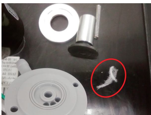
図4 警報の原因となった破損したフィルタのメッシュ
