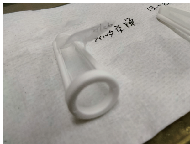
図5 2023年8月26日 軽く圧迫して破損したフィルタ
