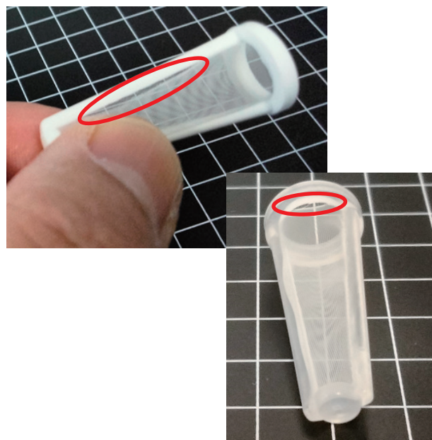
図10 既存フィルタ38週目注2の様子(上) 改良フィルタ34週目の様子(下)
