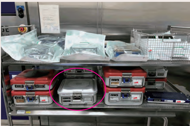
図14 蒸気滅菌における日常的な積載の例 (赤丸箇所=コールドスポット)
