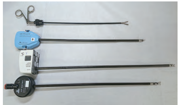
図2 鉗子の種類(上から腹腔鏡手術用、Da Vinci Si、Da Vinci Xi、hinotori)
