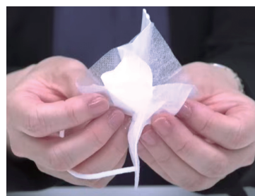
図3 サージカルマスクの3層構造(断面写真)
