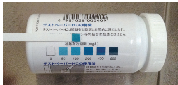
図2 濃度が低下している次亜塩素酸ナトリウム
