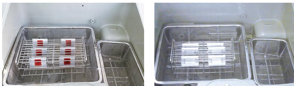
図2 テストピースの設置方法
