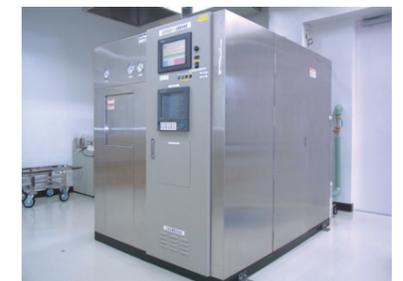
CIERは、通常の滅菌器よりも短時間で設定した滅菌条件に達します。
