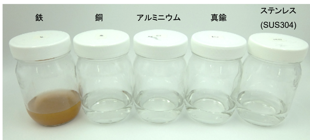
図 3 各種テストピースを浸漬した試験液の外観
