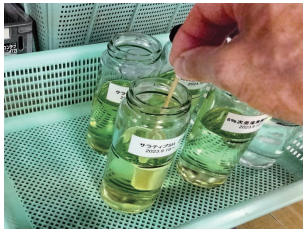
図8 プロセス② 毎日1回フィルタを原液内で混和
