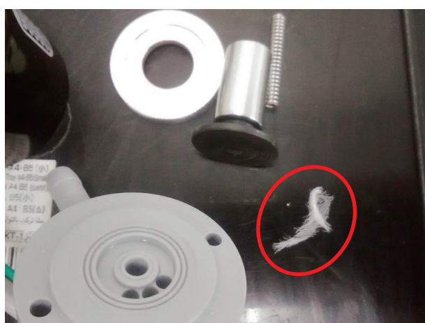
図4 警報の原因となった破損したフィルタのメッシュ
