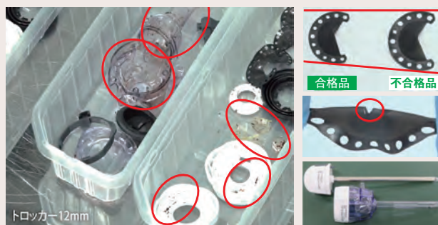
写真1 部品レベルまで分解したSUD 内部に隠れた破損や亀裂、膨潤や汚れを発見除去する
