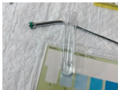
図10 比色ゲージにて残留 蛋白質量を測定して いる様子 結果：0～10 \mu gでした
