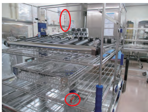
図13 手術支援ロボット用鉗子洗浄時のインジケータ設置の様子 通常のインジケータと内腔用のインジケータの両方を設置しています
