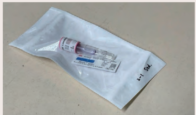
図9 過酸化水素ガスプラズマ滅菌は外部PCDによるモニタリング
