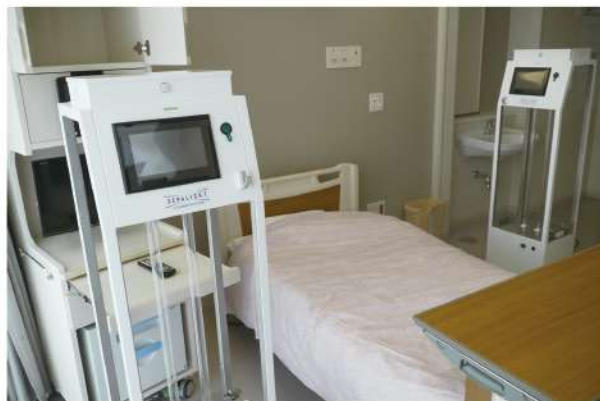
▲紫外線照射装置SEPALIGHT(サラヤ㈱)使用の様子 (愛媛県 住友別子病院より写真提供)
