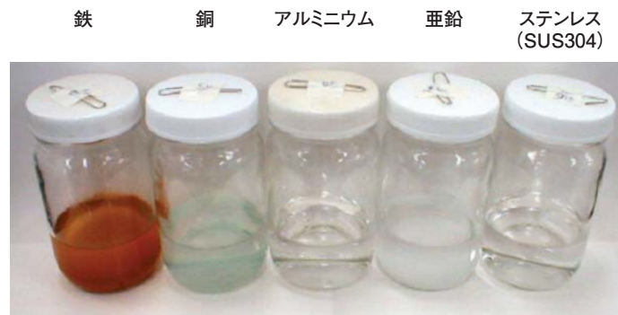
図3 各種テストピースを浸漬(37℃ 7日間)した「サニクイック」溶液の外観変化
